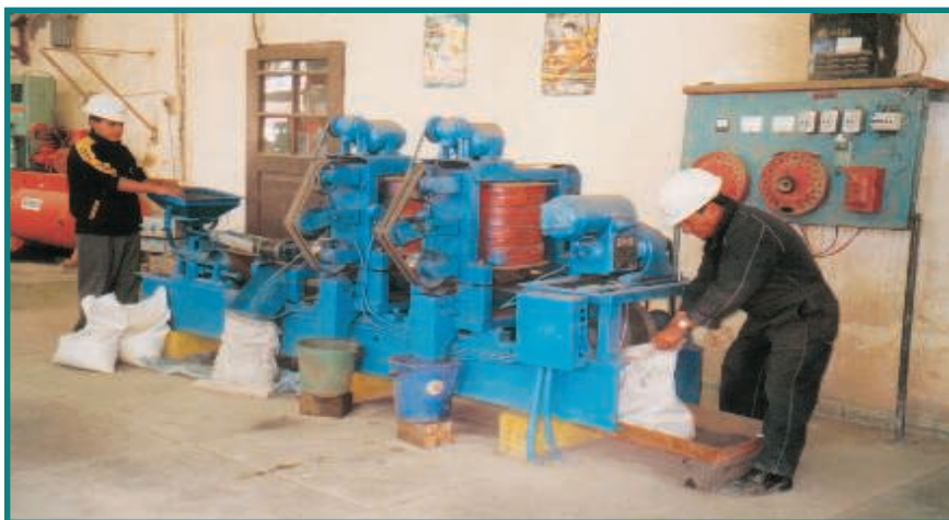
Equipo de Separación Magnética de bandas cruzadas HCB tipo Rowand & Wetherill.
